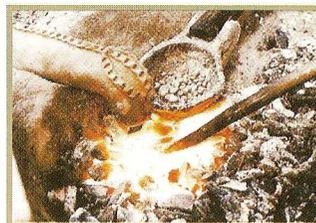
Si pongono i metalli (rame 92% e stagno 8% circa) a scaldare nel crogiolo sopra le braci tenute ad alta temperatura (circa 1100 gradi) soffiando aria ed alimentando continuamente con carbone
