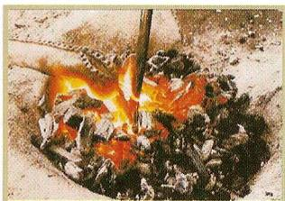
Il crogiolo viene posto sotto l'ugello in argilla del mantice, sono sufficienti da 5 a 7 minuti per la fusione. Lo stato del metallo si controlla notando il cambiamento di colore della fiamma e/o con un bastoncino
