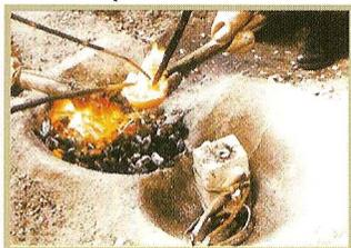
La matrice in arenaria entro la quale effettuare la colata è già pronta e stretta con lacci di cuoio tesi mediante cunei di legno. La fossa di fusione è
