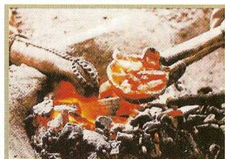
Una volta fuso il metallo, si estrae il crogiolo mediante una tenaglia in legno e si eliminano rapidamente i frammenti di carbone con un legnetto.
